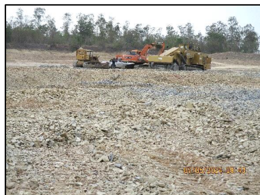
ภาพที่ 2.12 การเปิดหน้าเหมืองด้วยวิธีเหมืองทาบในลักษณะ Open Pit
