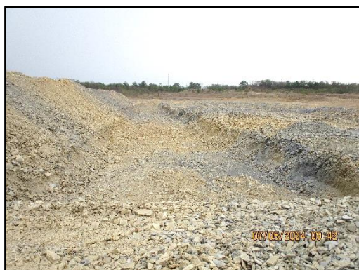
ภาพที่ 2.12 การเปิดหน้าเหมืองด้วยวิธีเหมืองทาบในลักษณะ Open Pit
